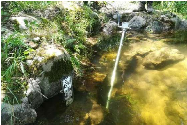
Echelle limnimétrique et puit de mesure avec sonde
