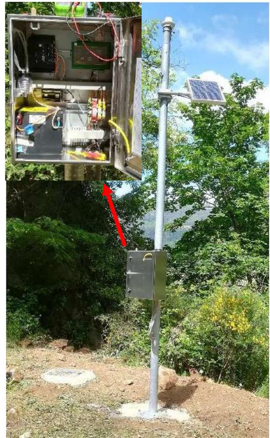
*Centrale d'acquisition, capteur de précipitation et panneau solaire*
